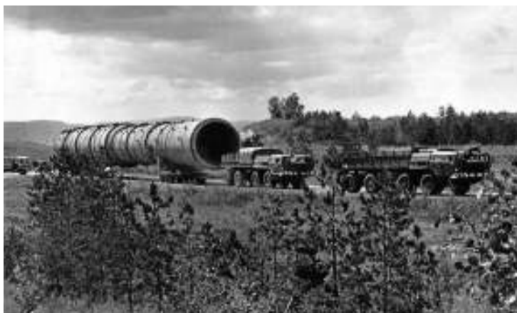
Полноприводные восьмиосные тягачи «Ураган» производства Минского автомобильного завода доставляли на площадку ТОАЗа негабаритное оборудование
